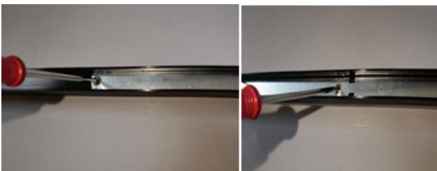
4. Nehmen Sie die Schrauben mit einem Schraubenzieher heraus und entfernen Sie dann das Aluminiumblech
