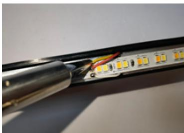
2. Entfernen Sie den Leiterplattenanschlussdraht mit einem Lötkolben
