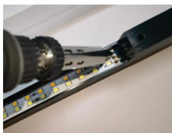
7. Entfernen Sie den Leiterplattenanschlussdraht mit einem Lötkolben
