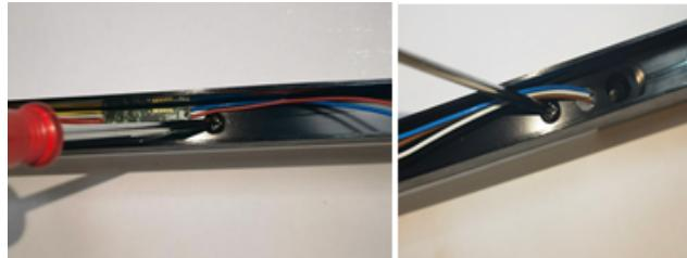
5. Die Schrauben mit einem Schraubenzieher herausdrehen
