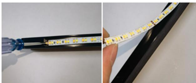
3. Heben Sie die Leiterplatte mit einem Schraubenzieher ab und ziehen Sie den Stecker der Leiterplatte heraus
