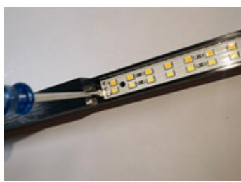
8. Heben Sie die Leiterplatte mit einem Schraubenzieher ab und ziehen Sie den Stecker der Leiterplatte heraus
